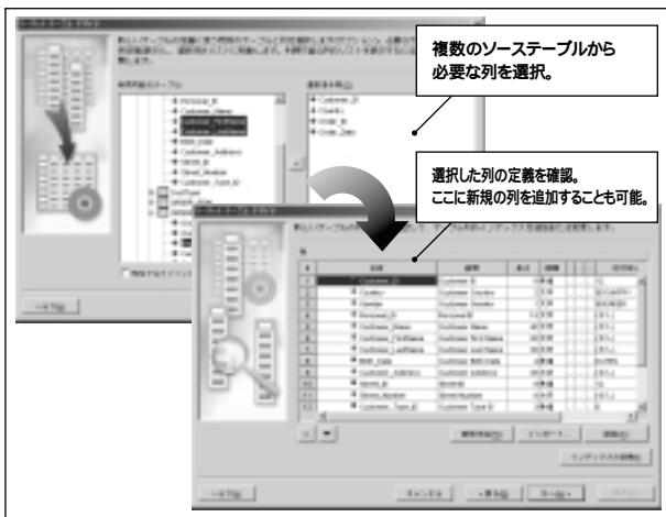
図4:ソーステーブルを元にしたターゲットテーブルの定義
